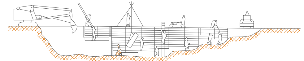
PROCESO DE ENTIBADOS POR ELEMENTOS TRADICIONALES
